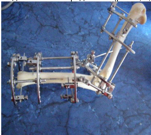
Рис. 4. Модель аппаратной конструкции, используемой при дистальных и околосуставных переломах плечевой кости
